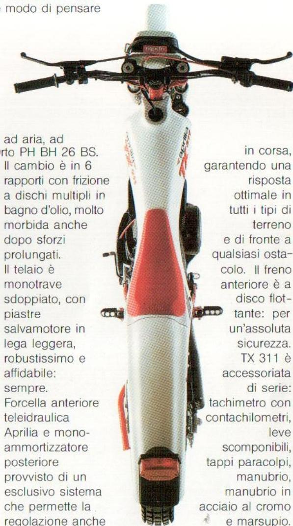
Il cambio è in 6 rapporti con frizione a dischi multipli in bagno d'olio, molto morbida anche dopo sforzi prolungati. Il telaio è monotrave sdoppiato, con piastre salvamotore in lega leggera, robustissimo e affidabile: sempre. Forcella anteriore teleidraulica Aprilia e monoammortizzatore posteriore provvisto di un esclusivo sistema che permette la regolazione anche
