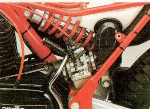
L'esclusivo AMMORTIZZATORE POSTERIORE è provvisto di un sistema di regolazione che permette, anche in movimento, di tarare il freno idraulico. Assicura una eccellente progressività e una risposta ottimale: su tutti i tipi di terreno e di fronte a ogni genere di ostacoli. Il FRENO ANTERIORE A DISCO FLOTTANTE, anche sottoposto a continui stimoli garantisce in qualsiasi situazione la massima stabilità e sicurezza.
